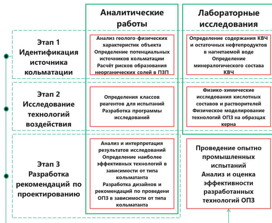
Рис. 1. Алгоритм выполнения работ по выбору технологий ОПЗ для нагнетательных скважин
