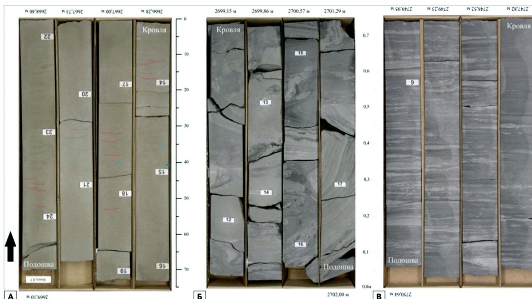
Рис. 2. Фото керна пласта БВ<sup>7</sup><sub>3-4</sub> с основными фациями осадконакопления: А – массивные песчаники, Б – переработанные и деформированные песчаники, В – гетеролитический песчаник и алевролит
