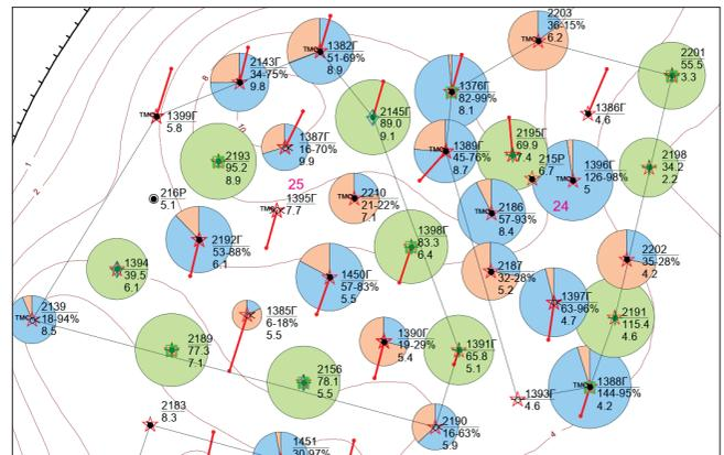
Рис. 4. Выкопировка карты текущего состояния разработки участка пласта БВ<sup>7</sup><sub>3-4</sub>
