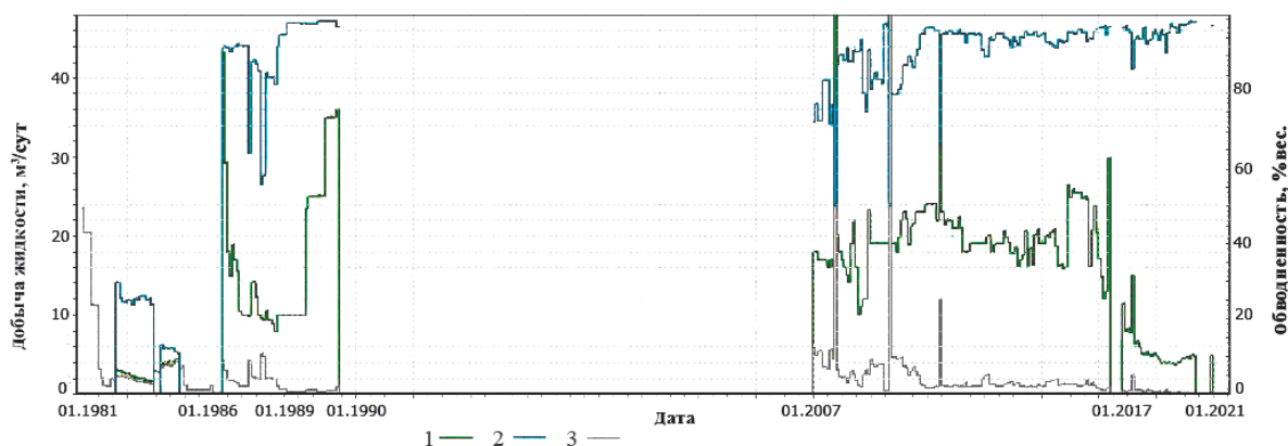
Рис. 7. График разработки по скважине. 1 – добыча жидкости, м³/сут; 2 – добыча нефти, м³/сут; 3 – обводненность, %, вес
