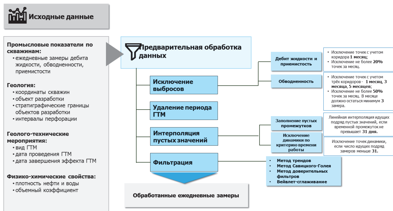
Рис. 1. Блок-схема автоматизированного процесса подготовки исходных промысловых показателей в модуле «Статистика»
