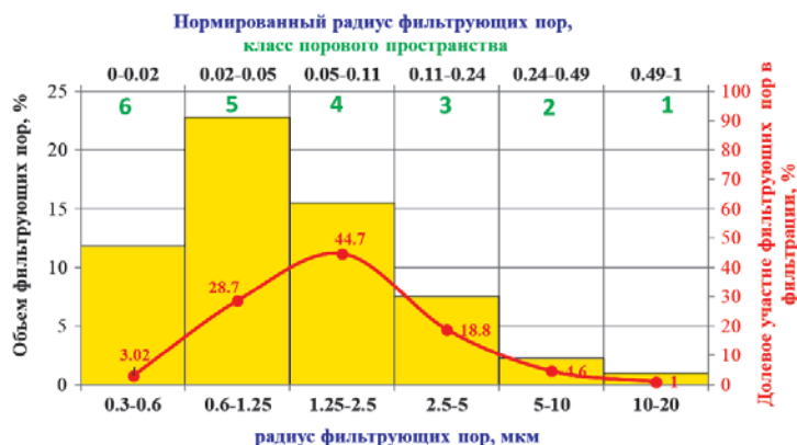
Рис. 5. Пример нормированных и реальных диапазонов радиусов фильтрующих пор и классов порового пространства
