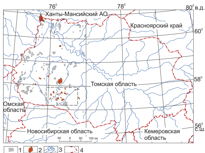
Рис. 1. Положение Останинской группы месторождений (контур черной пунктирной линией) на схеме размещения месторождений углеводородов Томской области. 1–2 – месторождение с залежами: 1 – в юрских и меловом НГК, 2 – в юрских, меловом и доюрском НГК; 3 – речная сеть; 4 – административная граница.
