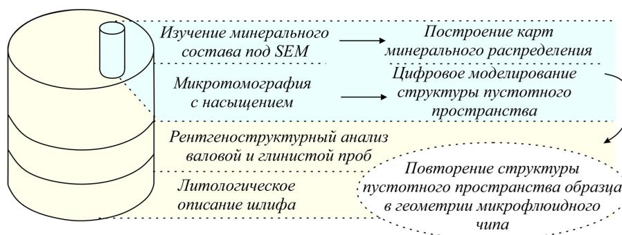
Рис. 1. План общего комплекса исследований стандартного образца ядра ачимовского песчаника и мини-ядра (фрагмента стандартного цилиндрического образца)
