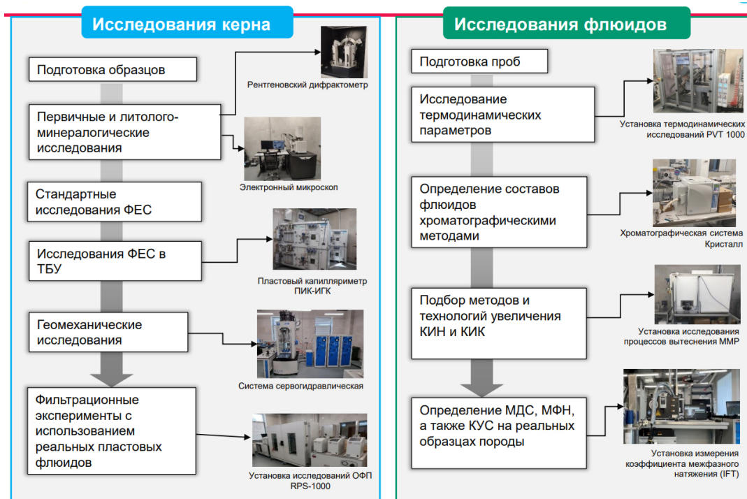
Рис. 10. Комплекс лабораторных исследований керна и пластовых флюидов на базе лабораторно-исследовательского центра в ООО «НОВАТЭК НТЦ»
