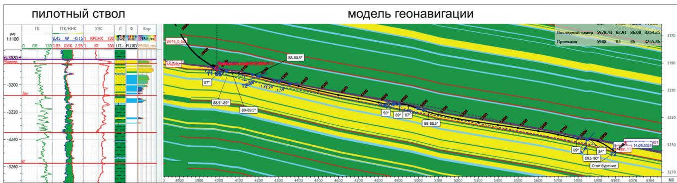
Рис. 1. Планшет геонавигации при бурении горизонтального ствола
