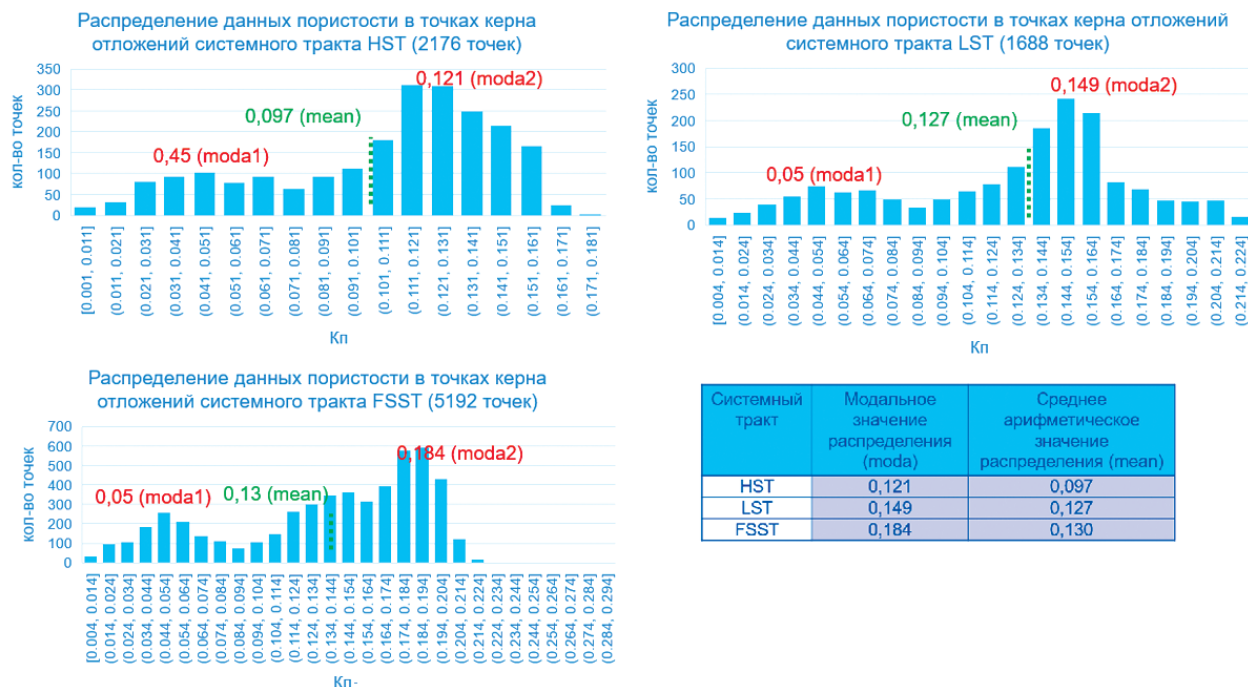
Рис. 8. Анализ распределения пористости в образцах керна с учетом их приуроченности к системному тракту
