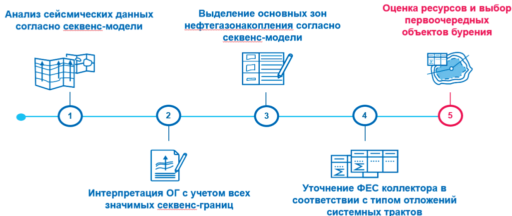
Рис. 9. Алгоритм реализации использования секвенс-стратиграфии в сейсмической интерпретации
