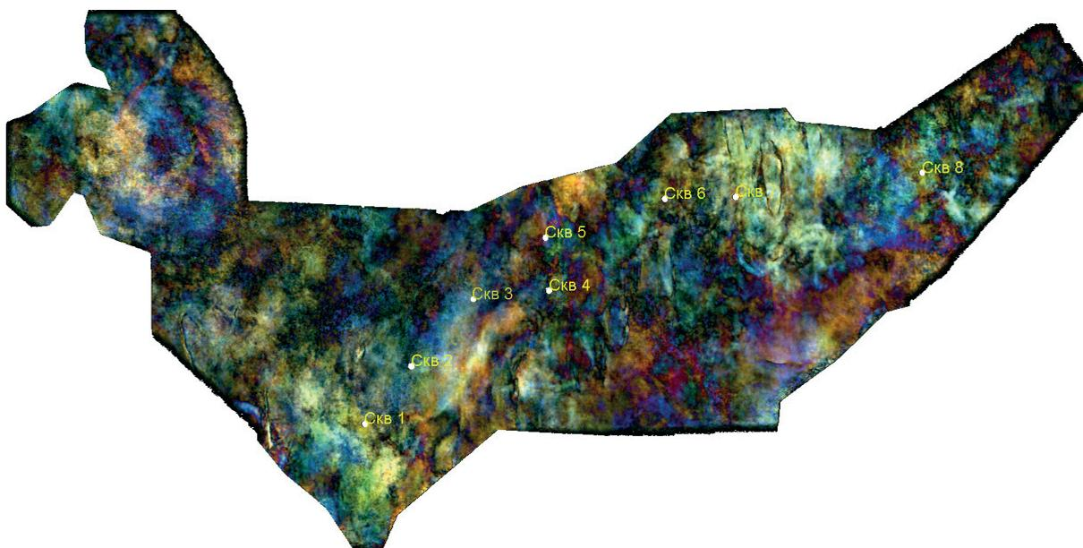
Рис. 1. Результаты спектральной декомпозиции по методу RGB суммирования вблизи кровли пласта Ю<sub>2</sub><sup>1</sup>
