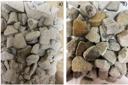
Рис. 2. Внешний вид керна до и после взаимодействия с карбонизированной пластовой водой в эксперименте № 1
