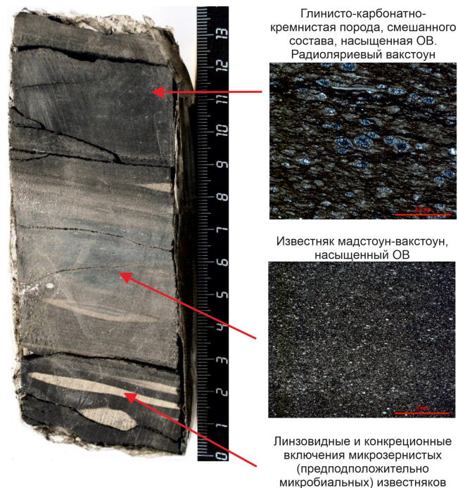
Рис. 3. Переслаивание различных литологических типов отложений в средней части разреза депрессионного типа, гл. 1475,7 м. Фотографии шлифов соответствующих литотипов выполнены в поляризованном свете.
