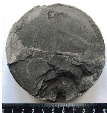
Рис. 4. Типичные тонкослоистые аргиллиты верхней терригенной части депрессионного типа разреза, пл. 1452, 1 м
