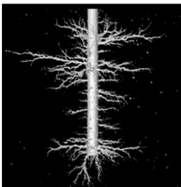
Рис. 4. Структура червоточин вблизи цилиндрического канала (модели скважины) после закачки раствора кислоты в карбонатную (из кальцита) масштабную модель пласта (McDuff et al., 2010)
