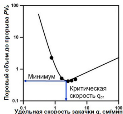
Рис. 3. Данные фильтрационных экспериментов из работы (Yoo et al., 2021). Критические параметры формирования доминантных червоточин. q – удельная скорость закачки, см/мин, q_{cr} – критическая скорость закачки, см/мин, PV_b – поровый объем закачанного реагента до прорыва кислоты, безразмерный.
