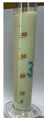
Рис. 8. Внешний вид кислотного состава после отстаивания в течение одного часа
