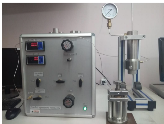
Рис. 3. Газовый порозиметр – пермеаметр Пласт-215АТМ
