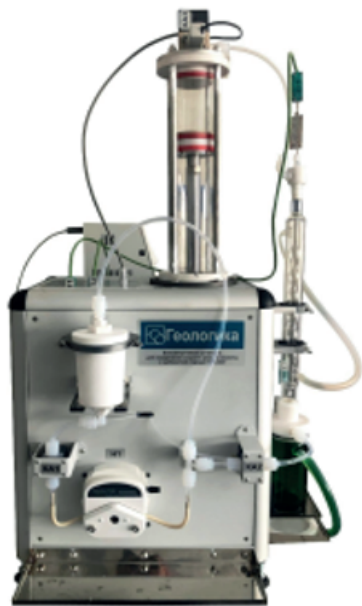
Рис. 9. Внешний вид волюметрической установки ПИК-ОСГ
