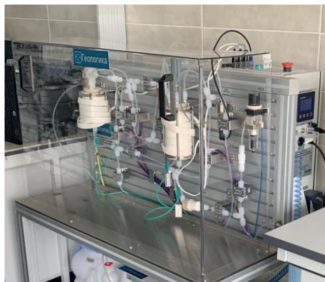
Рис. 11. Внешний вид установки вращающегося диска
