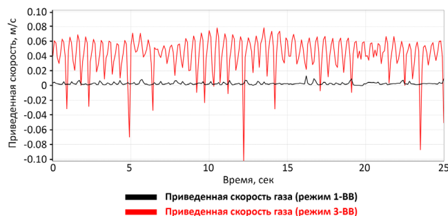
Рис. 12. Динамика скоростей газа и жидкости в затрубном пространстве над входом в приемный модуль для режимов 1-BB и 3-BB, рассчитанных в симуляторе OLGA 3
