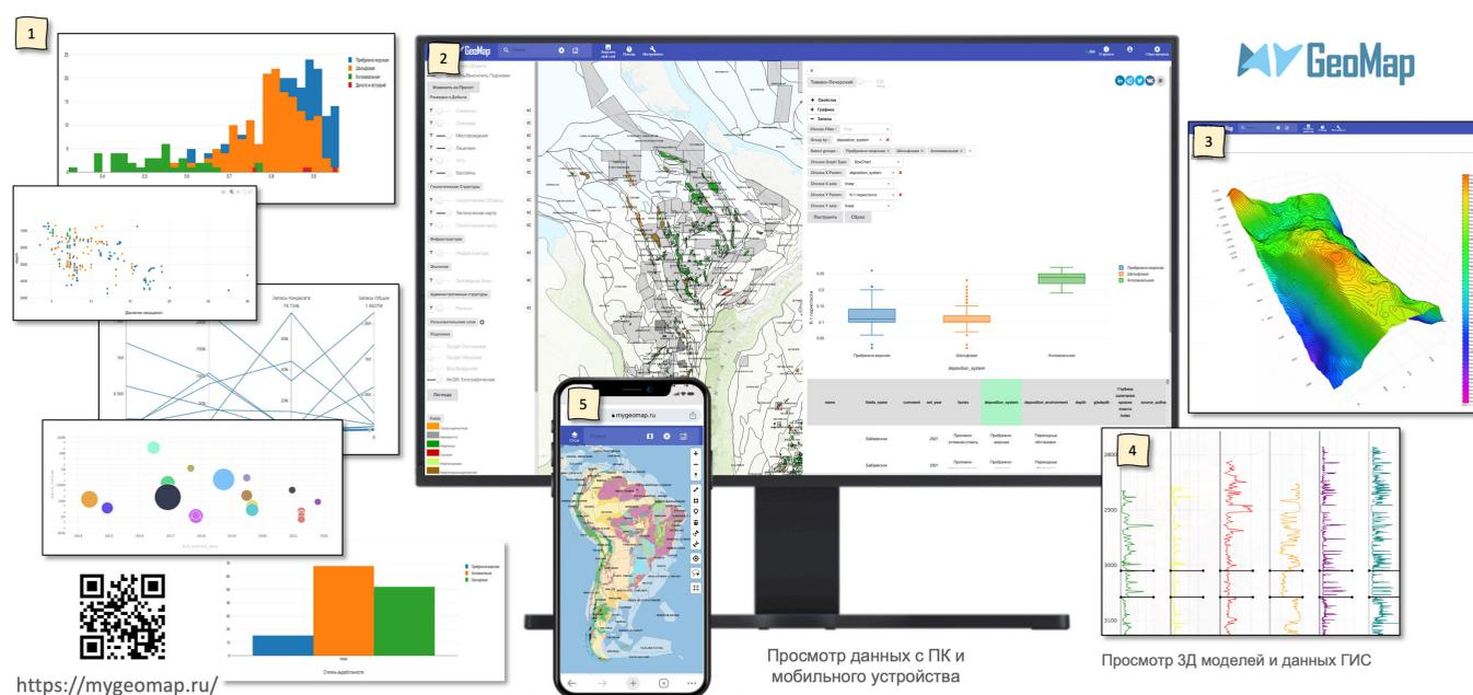
Рис. 2. Функционал платформы MyGeoMap. 1. Интерактивные графики по различным параметрам. 2. Пример интерактивной карты с визуализацией осадочных бассейнов, лицензионных участков и месторождений, а также результата работы алгоритма геостатистики. 3. Пример визуализации 3D сетки. 4. Пример визуализации кривых ГИС. 5. Пример работы платформы на мобильном устройстве.
