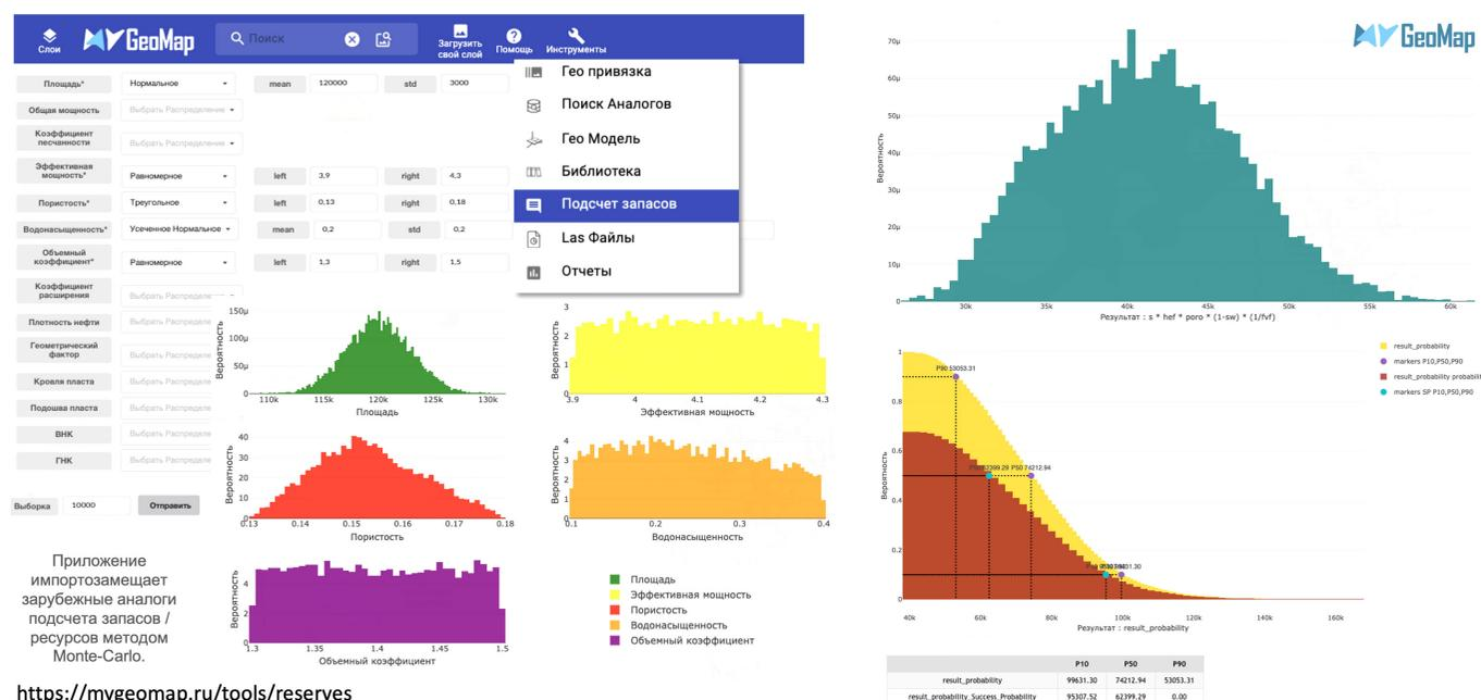
Рис. 4. Пример работы инструмента подсчета запасов / ресурсов вероятностным методом (Monte-Carlo) с геологическим риском
