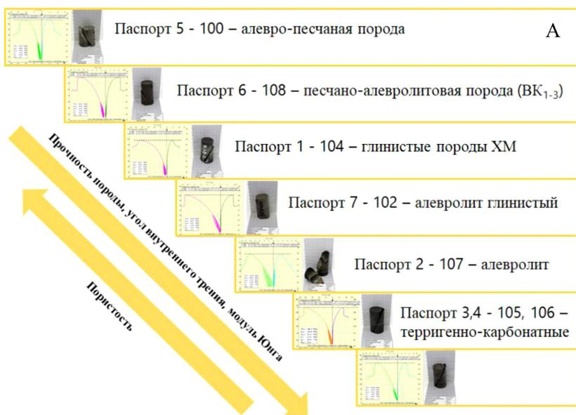
Рис. 16. Геомеханические исследования литотипов – создание механических фаций: А) паспорта прочности групп литотипов (Корреляция литофизические типы – упруго-прочностные свойства)
