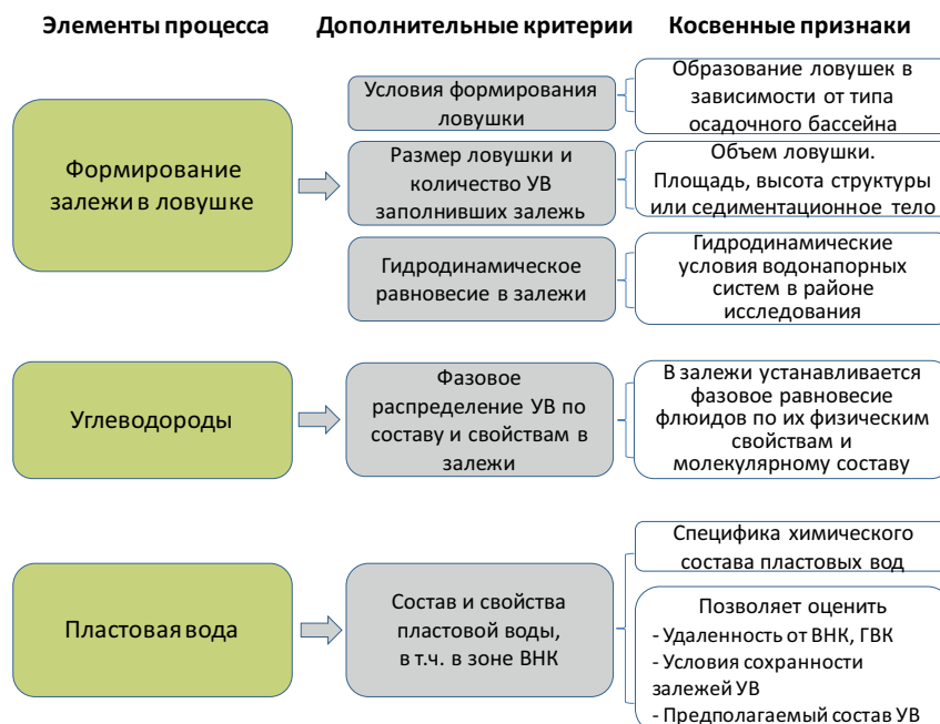
Рис. 7. Процесс аккумуляции углеводородов. Элементы процесса и критерии его определения
