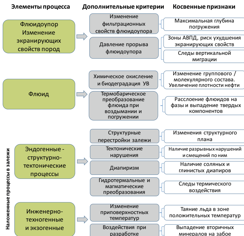
Рис. 9. Постаккумуляционные процессы в залежи: элементы процесса и критерии его определения
