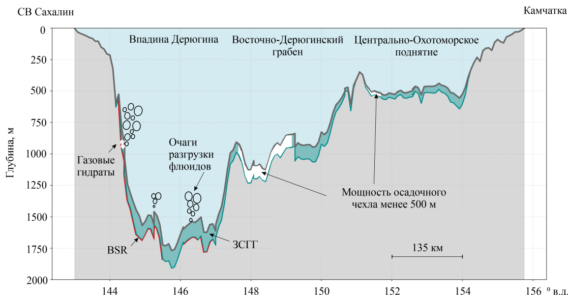
Рис. 7. Разрез по профилю СВ Сахалин – Камчатка через газогидратный резервуар в Охотском море; зеленым показана ЗСГГ, красная линия – скопление гидратов, маркируемое BSR; белые ромбики представляют положение придонных скоплений газовых гидратов в очагах разгрузки газа
