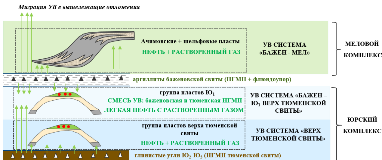
Рис. 15. Генерализованная схема строения углеводородных систем в периметре работ
