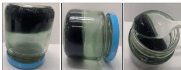
Рис. 5. Композитный селективный материал, состоящий из силикатного наполнителя, ПАА и ацетата хрома
