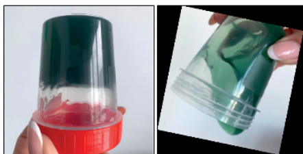
Рис. 4. Композиция на основе ПАА со сшивателем ацетатом хрома
