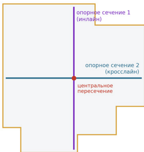
Рис. 3. Схема апробации: два опорных сечения, инлайн и кросслайн, пересекаются в центральной части площади и содержат исходную экспертную интерпретацию. Контур соответствует границе куба сейсморазведки 3D.
