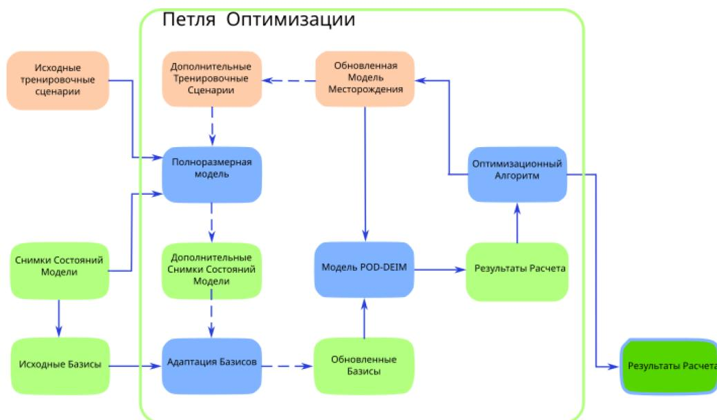
Рис. 11. Блок-схема применения метода адаптации базисов к оптимизационным задачам
