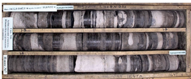
Рис. 2. Фотография фрагмента керна. Чередование карбонатных и карбонатно-кремнистых пород с высоким содержанием органического вещества. Скв. 946. Азбазовский участок. Глубина 1638–1641 м.
