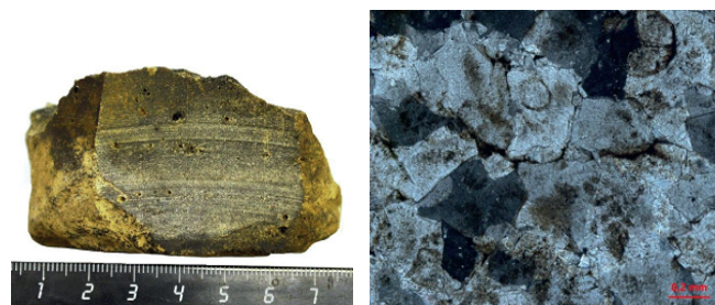
Рис. 4. Вторичный доломит нефтенасыщенный с неконформной структурой. Березовская площадь. Скв. 25276. Гл. 1681,25 м. Слева фотография образца, справа его шлифа (один николь).
