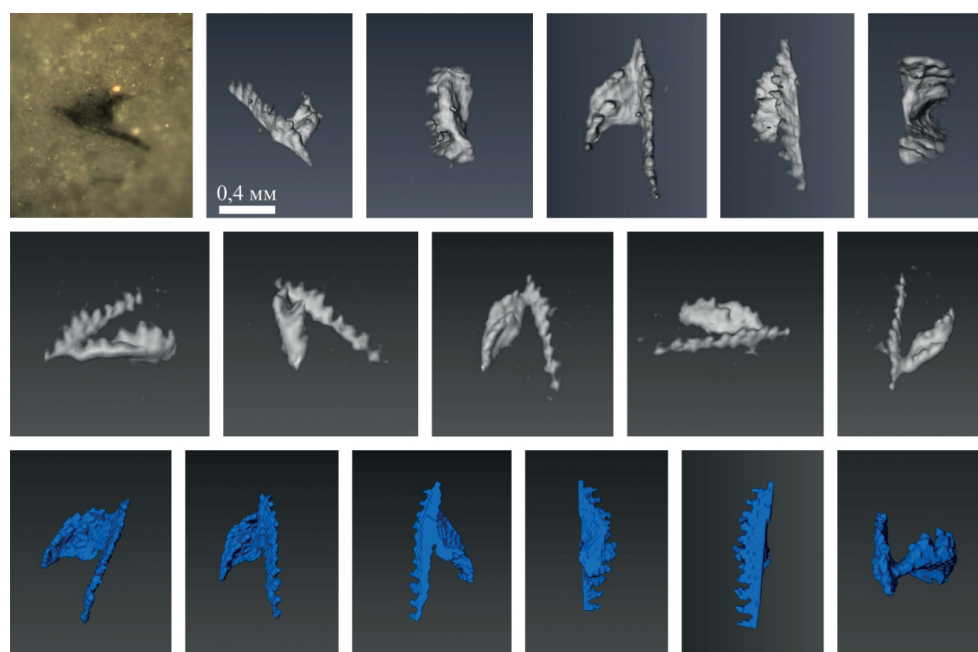
Рис. 8. Фотография среза (слева сверху) и объемные реконструкции конодонта Ancyrodella sp. до реакции (верхний ряд), после реакции (средний ряд) и пустоты, оставшейся после его растворения (нижний ряд)
