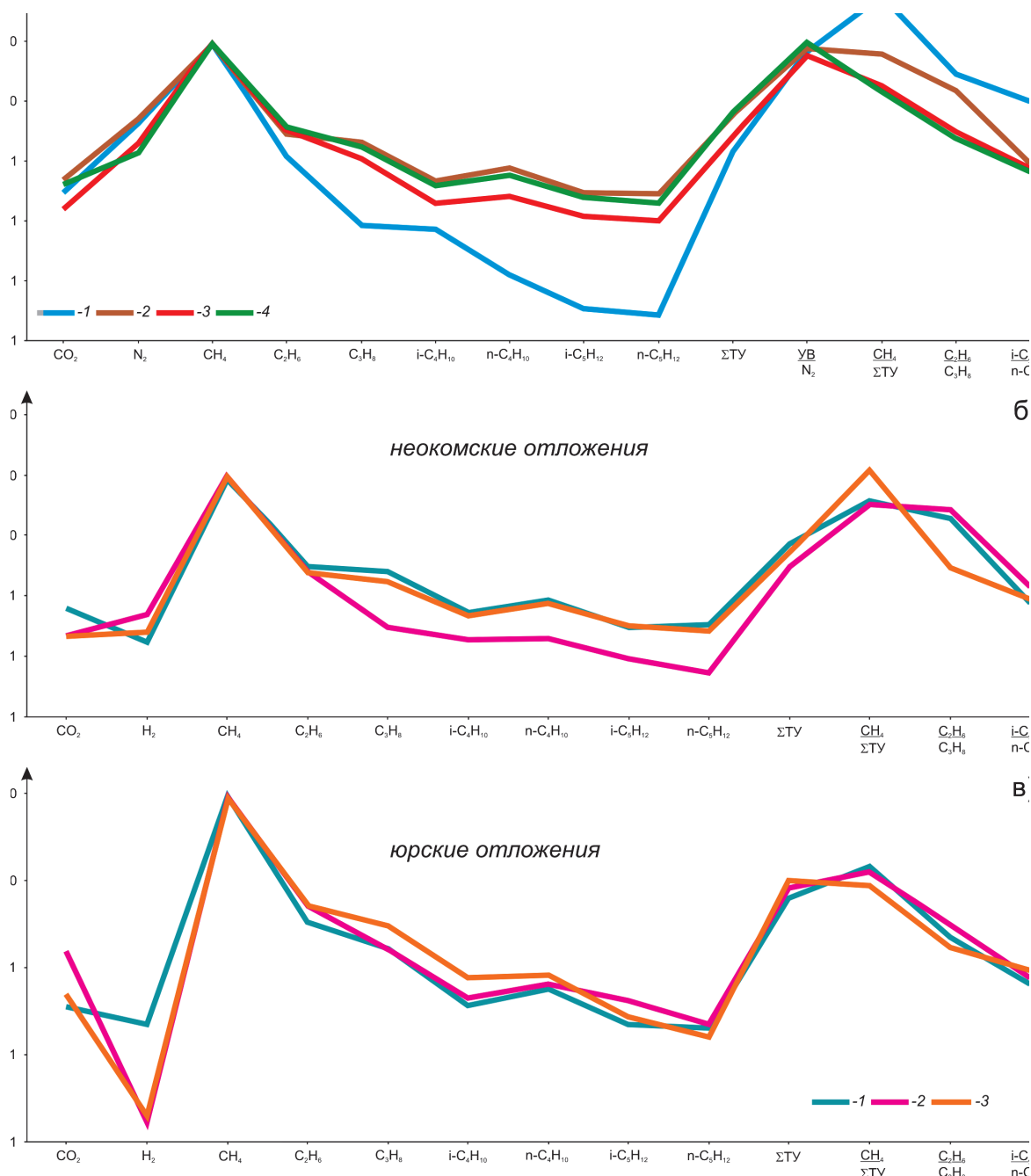
Рис. 3. Средний состав ВРГ нефтегазоносных отложений зоны сочленения Енисей-Хатангского и Западно-Сибирского бассейнов с учетом основных геохимических коэффициентов ( \text{CH}_4/\Sigma\text{TU} , \text{C}_2\text{H}_6/\text{C}_3\text{H}_8 и i\text{-C}_4\text{H}_{10}/n\text{-C}_4\text{H}_{10} ). а) водоносные комплексы: 1 – апт-альб-сеноманский, 2 – неокомский, 3 – верхнеюрский, 4 – ниже-среднеюрский. б-в) изученные районы: 1 – Енисей-Хатангский бассейн, 2 – Мессояхская наклонная гряда, 3 – Западно-Сибирский бассейн.
