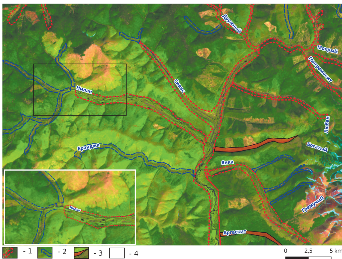
Рис. 3. Синтезированное цветное изображение участка Кербинского золотоносного узла. Снимок Landsat 8, спектральные полосы 6-5-4. 1 – полигоны дражной отработки; 2 – полигоны гидравлической отработки россыпей; 3 – полигоны комбинированной отработки; 4 – участок врезки.
