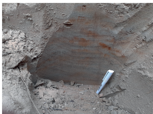
Рис. 3. Продуктивный пласт Итмановской россыпи: темные прослои содержат повышенные концентрации рудных минералов – ильменита, хромита и циркона
