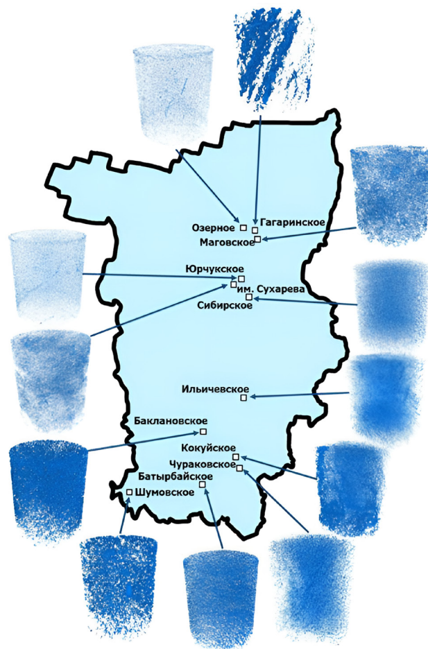
Рис. 1. Схематичное расположение нефтяных месторождений на карте Пермского края с отмеченными особенностями строения пустотного пространства коллекторов (карбонатные пласты C2b-C1s)
