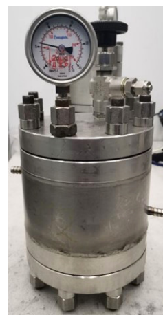
Рис. 2. Барокамера для искусственного гидратонасыщения грунтовых образцов (производство ООО «Криолаб» совместно с ЦКП «ФабЛаб и Мастерская», Россия)
