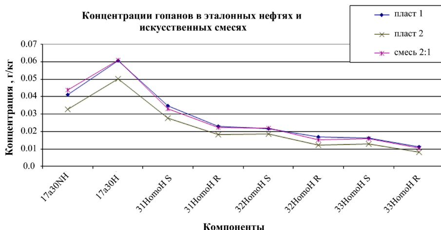
Рис. 7. Пример показателей, не соответствующих критерию нахождения смеси внутри диапазона эталонных нефтей (показатели не подходят для расчетов)
