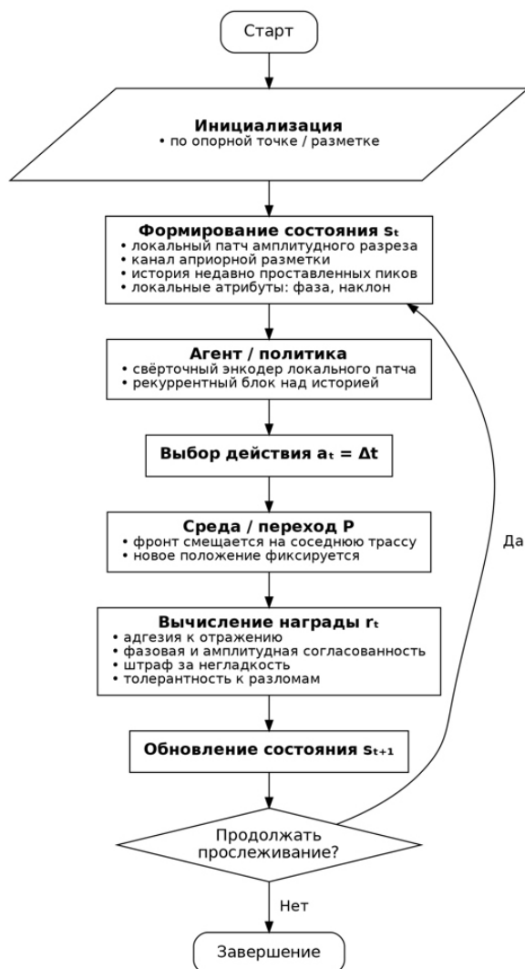
Рис. 2. Прослеживание отражающего горизонта как марковский процесс принятия решений M = (S, A, P, R, \gamma) и двухэтапная схема построения поверхности. На каждом шаге состояние s(k) включает локальное амплитудное окно, опорную разметку, историю предыдущих отсчётов и локальные атрибуты. Политика выбирает смещение a(k) = \Delta t(k) на соседней трассе, после чего рассчитывается награда, включающая корреляционное сходство волновой формы с опорным отражением, фазовую и амплитудную согласованность, штраф за негладкость и ослабление этого штрафа в зоне нарушения. На первом этапе выполняется корреляция по системе сечений с шагом 50 линий; на втором – заполнение промежутков между опорными сечениями до сплошной поверхности H(x, y) .
