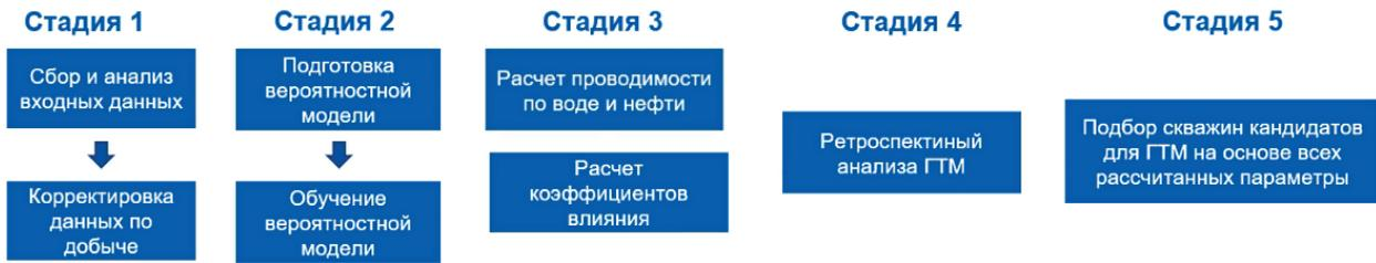
Рис. 14. Структура методики оптимизации разработки
