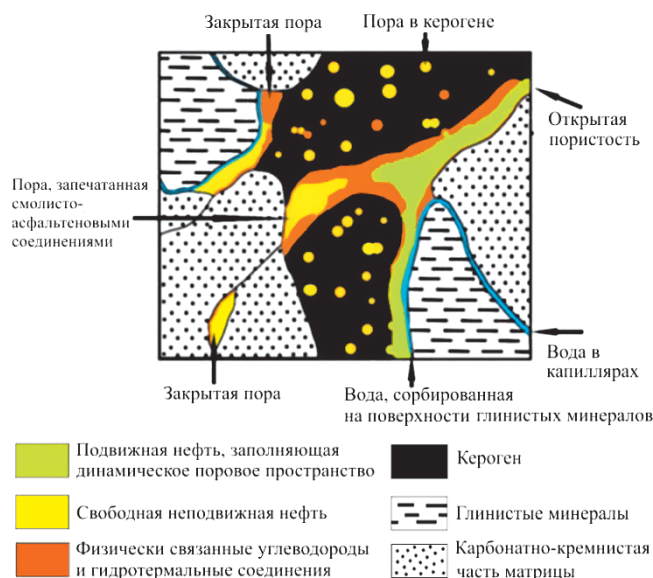
Рис. 2. Схема, иллюстрирующая строение пустотного пространства высокоуглеродистых формаций (Калмыков Г.А., 2017)
